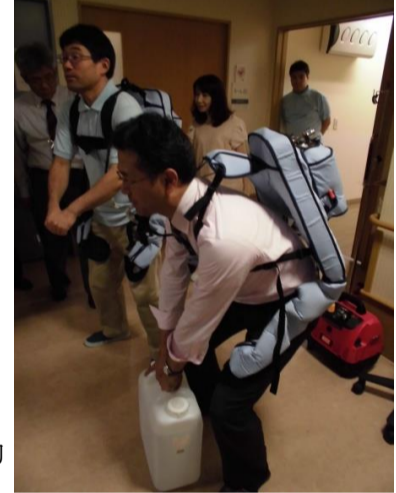
動作補助装置「マッスルスーツ」
